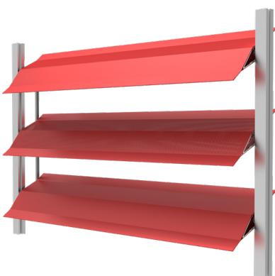
Celosías Brise Soleil Serie BR de lamas fijas y orientables de sección prismática, de acero galvanizado conformada, lacada y termoendurecida en sistema al polvo e instaladas en montante o marco de aluminio extruido con greleta de orientación.
