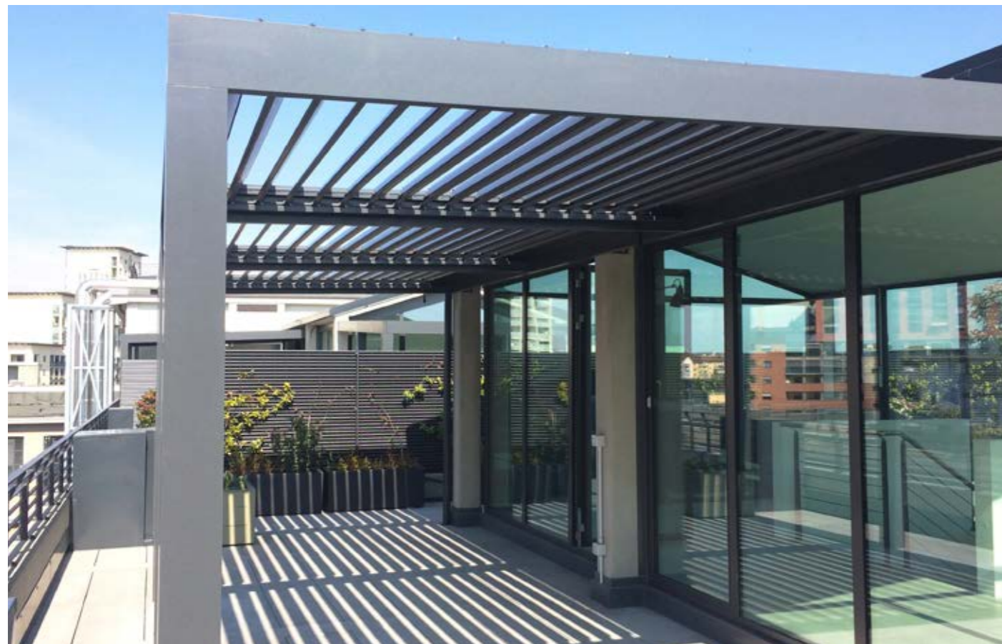
Biopergola con estructura portante de aluminio compuesto por vigas perimetrales de aluminio extruido de 200 x 50 mm con canalón adosado de aluminio extruido de 100 x 50 mm para la recogida del agua hacia el interior de los pilares verticales de aluminio extruido de sección 150 x 150 mm. Posibilidad de instalación de iluminación lineal led en toda la continuidad del canalón perimetral.
